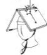
頭頂部を前にずれて落下物が当たった場合、笠自体が前に傾斜して力を逃がす。
