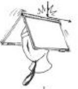
笠の稜線の中央部に落下物が当たった場合、笠が変形して衝撃を吸収して、首への負担を軽減する。
