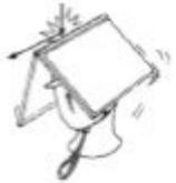
頭頂部を後ろにずれて落下物が当たった場合、笠自体が後ろに傾斜して力を逃がす。
